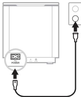
Une fois connecté, le module de basses se met sous tension.
