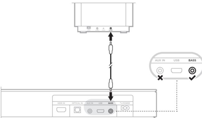
Conecte un cable de audio de 3,5 mm (no suministrado) al conector **BASS IN** del módulo de bajos y al conector **BASS** del altavoz (no al conector **AUX IN**).
