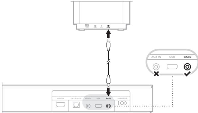
Raccordez un câble audio de 3,5 mm (non fourni) au connecteur BASS IN du module de basses et au connecteur BASS de l'enceinte (et non pas au connecteur AUX IN).
